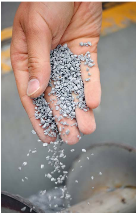
Bild 1: Innovatives Abstreumaterial aus UHPC mit Titandioxid
